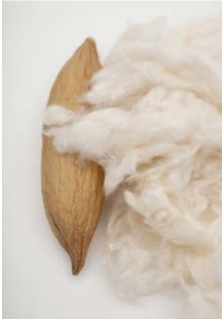
เมล็ดและเส้นใยฝู่น MC# 6805-01; Material ConneXion
