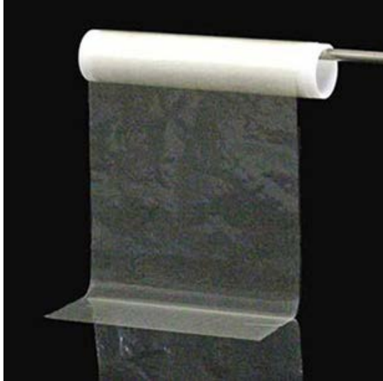
แผ่น CNF ใสแผ่นแรกของโลกที่ยาวติดต่อกันหลายร้อยเมตร (ที่มาของรูป: Oji Holdings)
