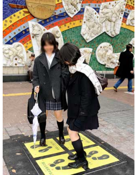
แผ่นกระเบื้อง Power-Generating Floors™ กำลังทดสอบที่สถานีชิบูย่า
